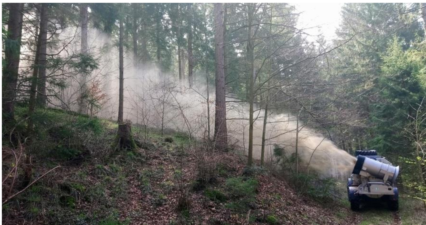
Abb. 46: Terrestrische Kalkausbringung mit dem Unimog (Foto: P. Hartmann)
